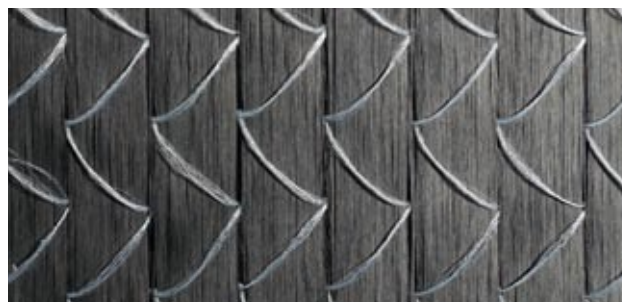
NC2-Gelege mit Faserorientierung 0/90 Grad
