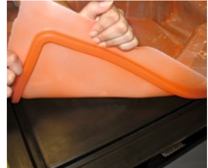
Entformen der fertiggestellten Haube
