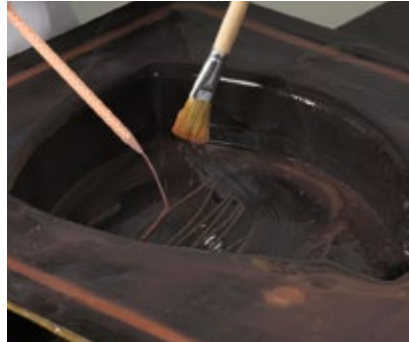
Verteilen des Silikons mit Pinsel
