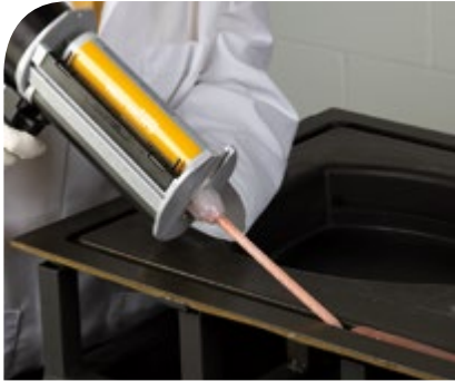
Auftragen von ELASTOSIL® C-1200 mit einer 2K-Spritzpistole.
