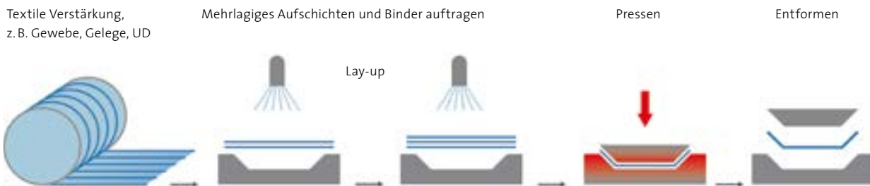
Schema der Preformherstellung mit EP-Binderpulver
