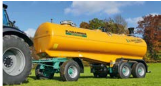
Zunhammer: leichte Gülle-Tankwagen aus GFK
