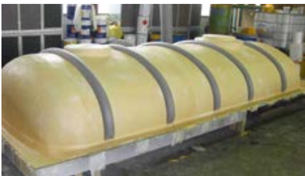
Formenbau mit OPTIMOLD II®; siehe auch Anleitung Formenbau ab S. 158
